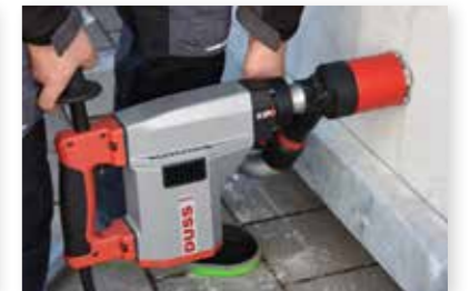
Einsatz des einschraubbaren Zusatzhandgriffs für ergonomisches Arbeiten
