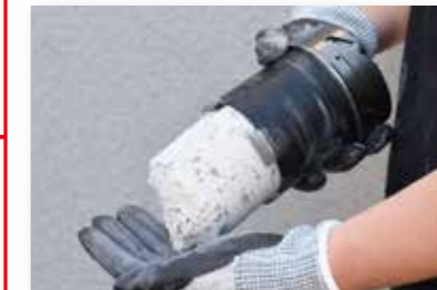
Schnelles Bohrkernentfernen dank Schnellwechselsystem
