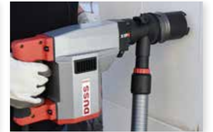
Dosensenken mit oder ohne Softschlag in Mauerwerk mit Dosensenker DS 82
